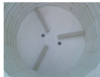
Innenseite mit Heizspiralen, Abstandhaltern und Zuluftöffnungen im Boden
